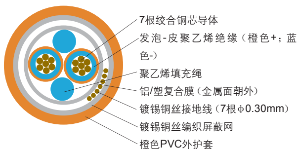
型号: TKFF-A 规格: 1 \times 2 \times 0.8\text{mm}^2 (18AWG)
